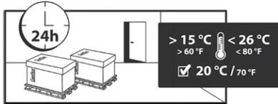
La instalación debe realizarse a temperaturas entre 15 y 26°C.
